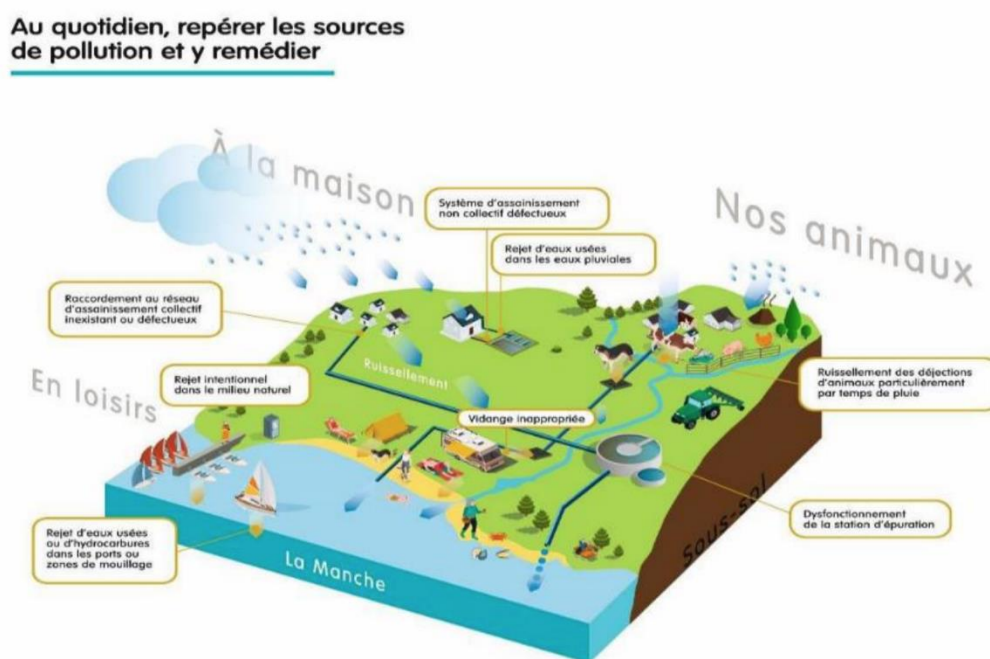
Figure n°4 : Schéma des sources de pollutions microbiologiques des eaux. Source : Guide du SAGE Léon-Trégor.
