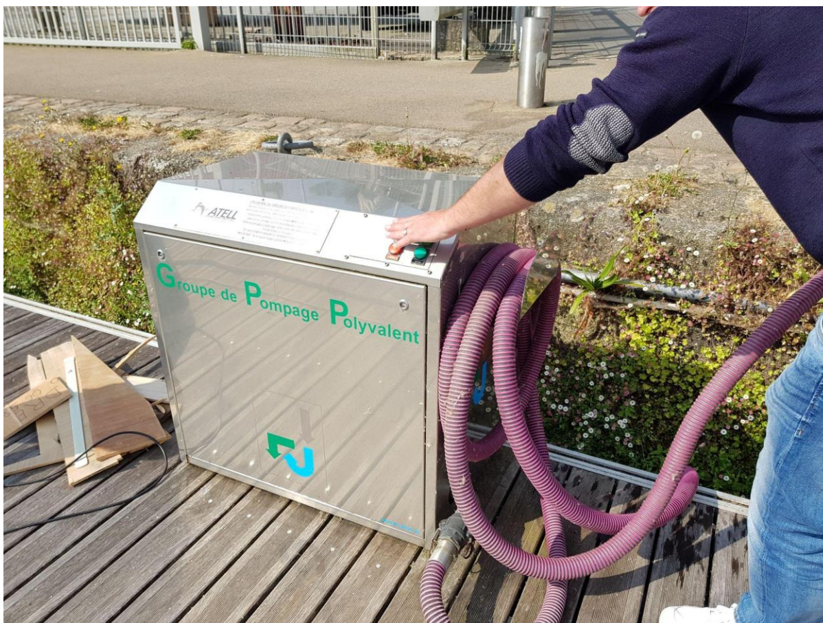
Figure n°31 : pompe à eau noire du port de Morlaix. © SAGE Léon-Trégor
